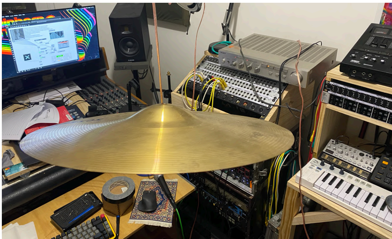
Figure 28 : Cymbale ride suspendue équipée de transducteurs en feedback
