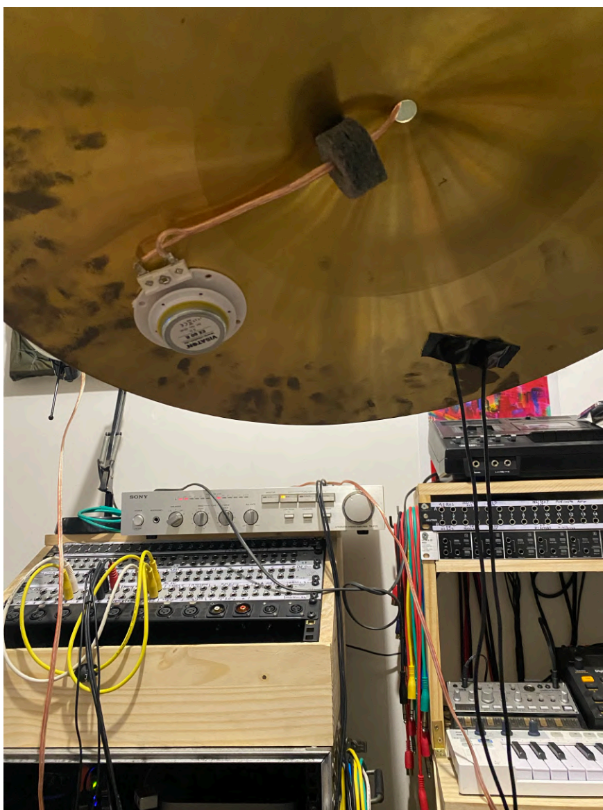
Figure 26 : Cymbale ride , équipée d'un excitateur et de microphone piézo, reliés par un amplificateur
